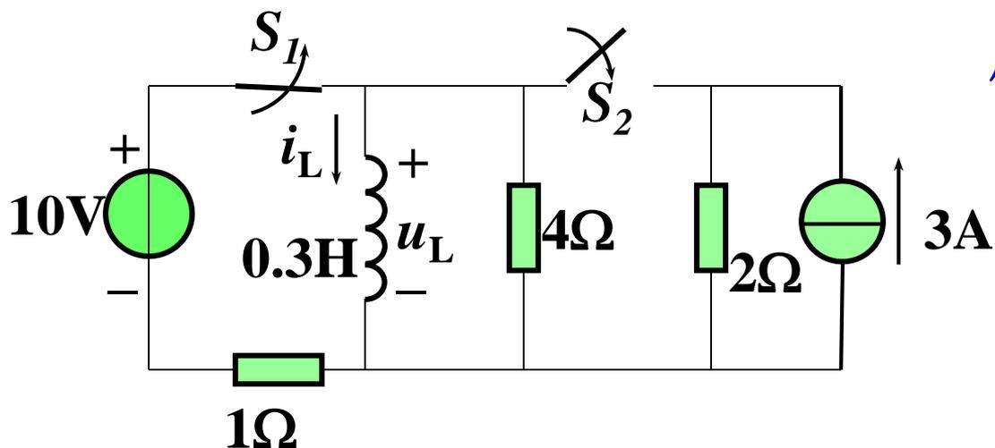
**例6-11**、图示电路中， $t=0$ 时将开关 $S_1$ 打开， $S_2$ 闭合。开关动作前，电路已经达到稳定状态，求 $t>0$ 时的 $i_L(t)$ ， $u_L(t)$ 。
