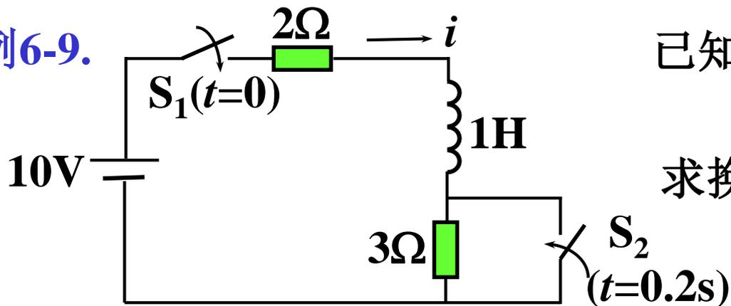
已知：电感无初始储能， $t = 0$  时合  $S_1$ ， $t = 0.2\text{s}$  时合  $S_2$ 。
