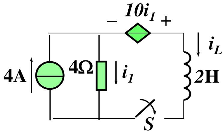
**例6-10**、图示电路中开关原先打开， $t=0$ 时将开关S闭合，已知 $i_L(0_-)=0$ ，求 $t>0$ 时的电流 $i_L(t)$ 。
